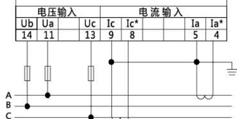
三相三线 电流经CT输入 电压直接输入
