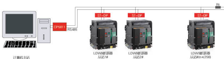
Profi bus-DP 协议通讯连接示意图
