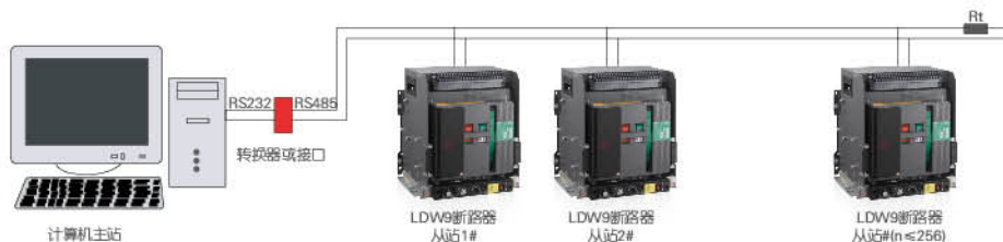
Mod bus 协议通讯连接示意图
